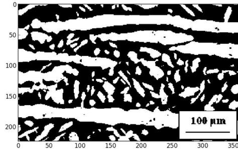
5) On a : % volumique de l'austénite =  $V_{\text{austénite}}/V_{\text{total}} = e.S_{\text{claire}}/(e.S_{\text{totale}})$
