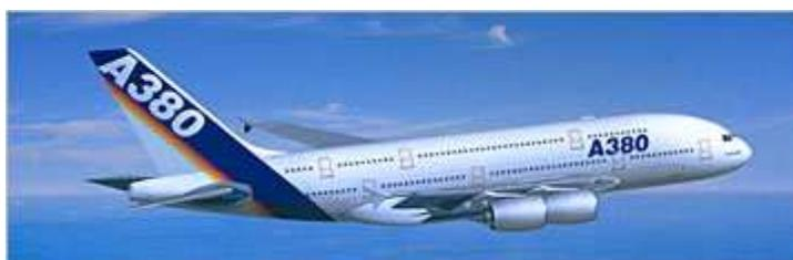
Au delà de ces chiffres intéressants directement les compagnies aériennes, on trouve des performances techniques impressionnantes : une masse de 560 tonnes au décollage entraînée par 4 turbopropulseurs de 30 tonnes de poussée, une altitude de croisière de 12 000 m et une vitesse de plus de 1 000 km/h. Des chiffres dont on peine à prendre conscience tant ils sont éloignés de nos références habituelles. Ces performances sont atteintes grâce à un système extrêmement complexe et pointu.
